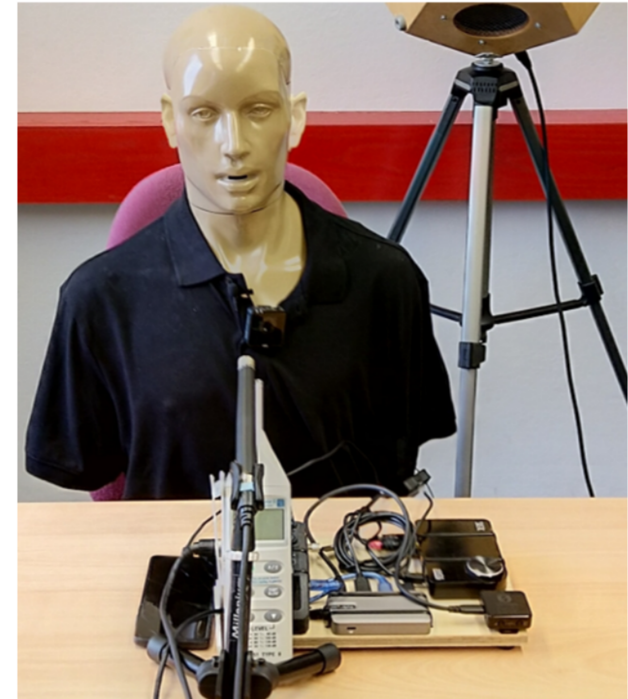
Abb. 1: Aufbau zur raumakustischen Bestandsaufnahme in 35 realen logopädisch genutzte Räume aus 8 Einrichtungen
